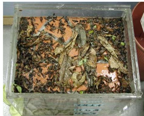
圖 7.4 模擬堵塞情形
