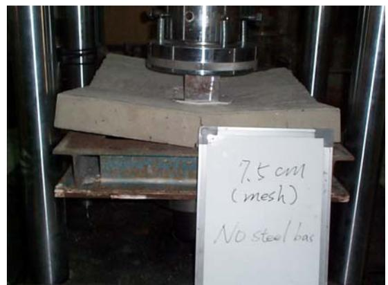
圖 7.1 75mm 加導水管架構混凝土板抗彎試驗
