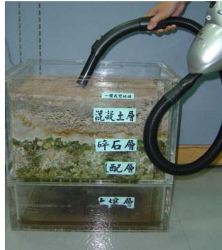
圖 7.3 透水率測試模型，及吸塵器清潔維護
